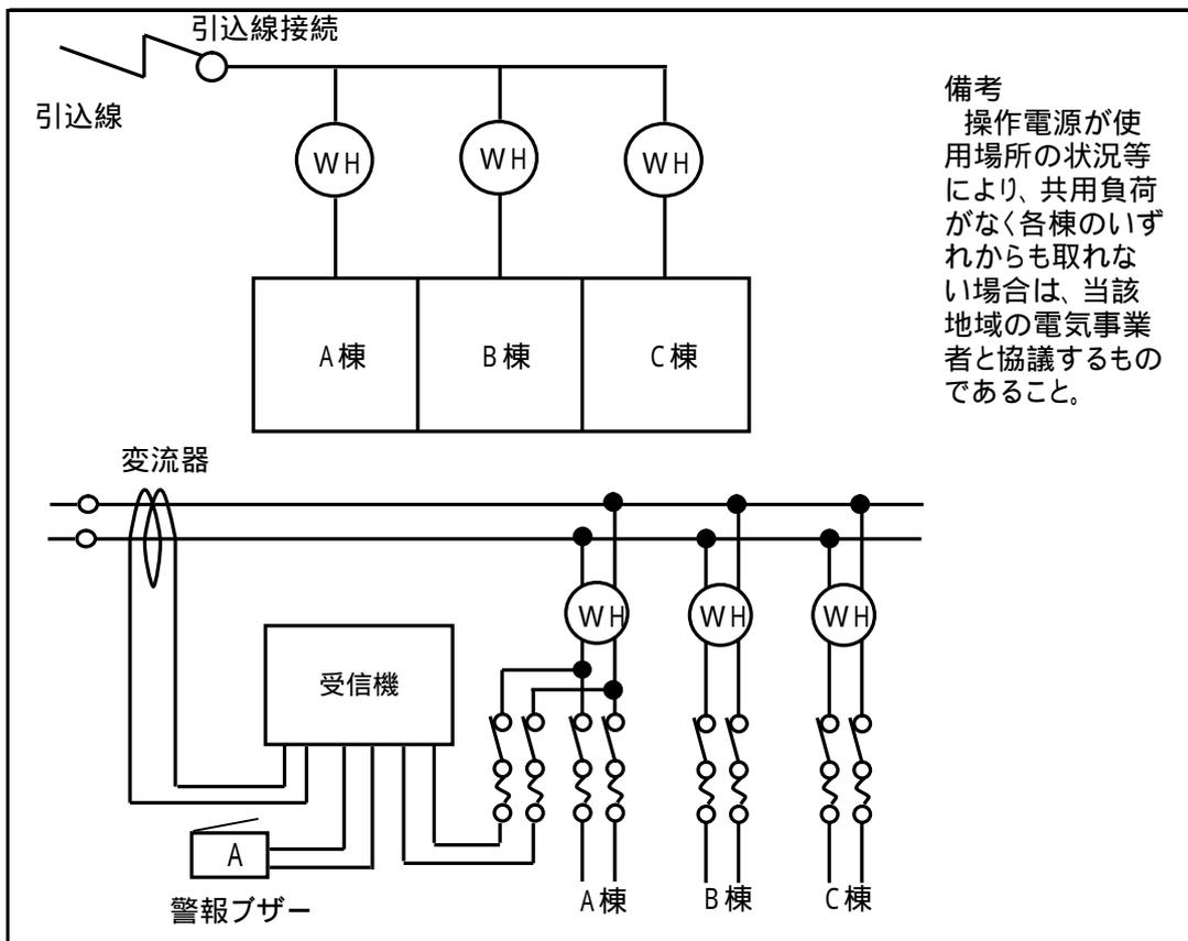
イ 各防火対象物に設けられている電力量計に至るまでの引込線が電気事業者の所有にかかる場合の例
