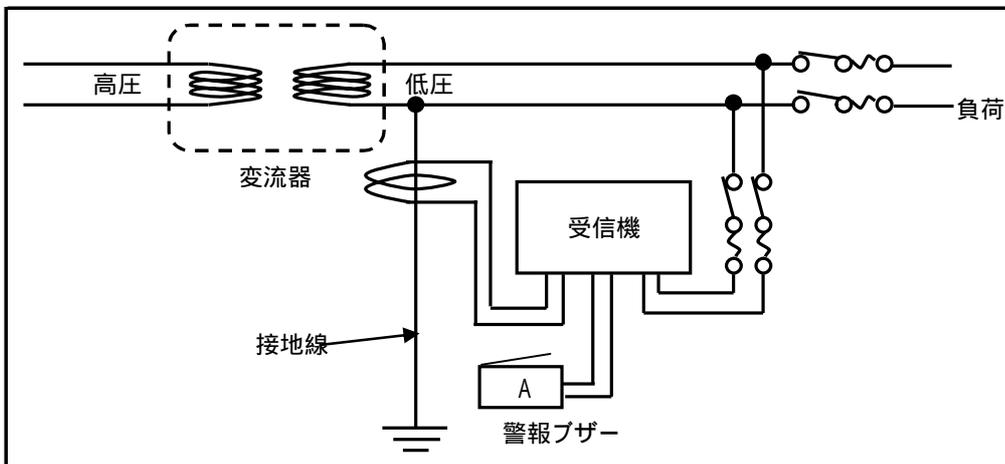
イ 単相3線式変圧器の接地線に設ける場合
