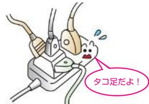
※コードや電源タップには、一度に流すことができる電流の量が決められています。決められた容量を超えて使用すると、発熱・発火し火災の原因となる恐れがあります。電源タップの電気の許容量を超えていないか、確認しましょう！
